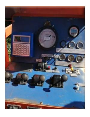
ΕI diseño de la unidad garantiza que los operadores puedan monitorear todos los interruptores, instrumentos y las condiciones de trabajo de todos los sistemas de manera conveniente y clara. Hay luces diseñadas cerca de la caja de instrumentos y el tanque de desplazamiento para operaciones nocturnas. La unidad está equipada con dos sistemas de protección para garantizar la seguridad tanto del equipo como del personal. Una de ellas es la válvula de seguridad de alivio ٧ overpressure.
